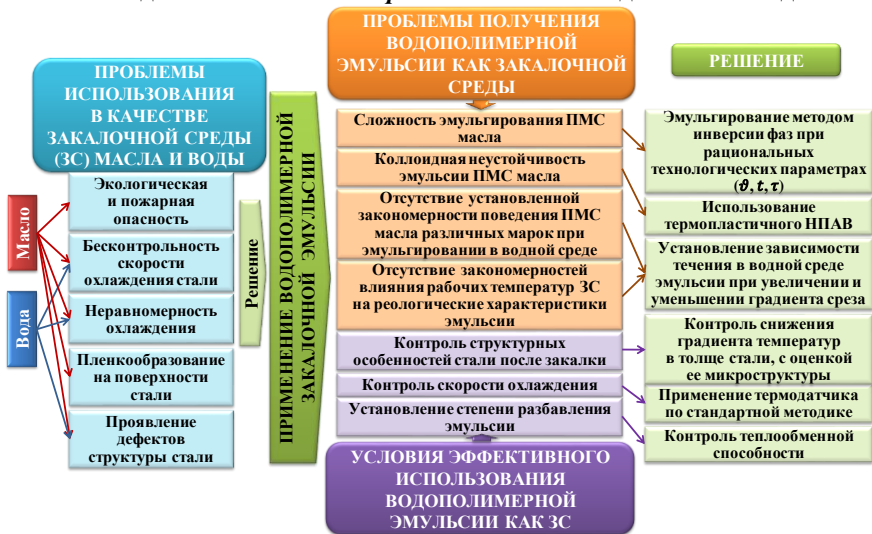
Рис. 1. Проблемы и пути их решения при создании водополимерных эмульсий для закалки стали
